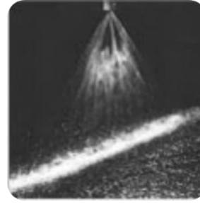
Yelpaze hüzmeli tarla ilaçlamasında en fazla tercih edilen meme tipidir.
